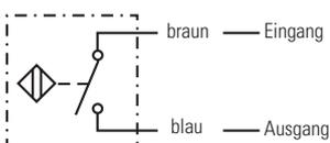
Die Grenzschalter werden in den Schlitzen des Schutzrohrs montiert und durch einen Magneten geschaltet, der sich im Inneren des Aktuators an der Kolbenstange befindet.
