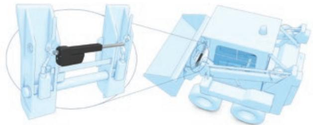
Schnellwechsler-Aktuatoren erlauben es dem Bediener eines Baggers oder Kompaktladers, die Anbaugeräte produktiv und sicher von seinem Sitz aus zu wechseln.
