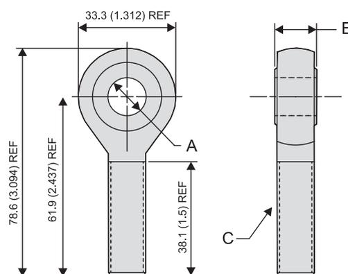
Der vordere Gelenkkopf-Adapter ist in metrischer oder Zoll-Ausführung erhältlich. Der metrische Adapter kann am vorderen Ende der Kolbenstange montiert werden, wenn der Aktuator mit dem optionalen metrischen Innengewinde-Adapter vorne (Typ P) ausgerüstet ist. Der Zoll-Adapter erfordert das optionale Zoll-Innengewinde (Typ G).
