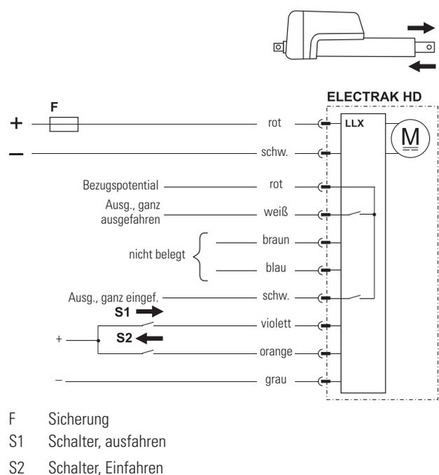
Steuerungsoption LLX entspricht der Option LXX, jedoch zusätzlich mit zwei Ausgängen, die angeben, wenn die Kolbenstange vollständig aus- bzw. eingefahren ist.
