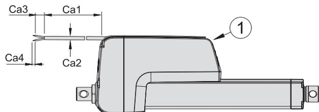
Hier werden die Kabel standardmäßig durch die Kabelschlitze am Ende des Aktuator-Gehäuses herausgeführt. Die Herausführung des Kabels kann beliebig zwischen dem Stecker (1) an der Gehäusevorderseite und dem Ende der Kabelschlitze gewählt werden.
