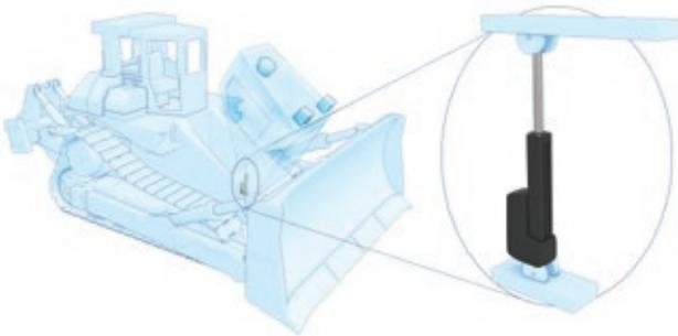
Mit Hilfe von elektrischen Linearaktuatoren gelangt ein einzelner Servicetechniker schnell und sicher an den Motorraum.
