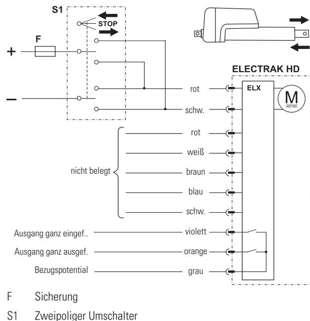
Steuerungsoption ELX entspricht der Option EXX, jedoch zusätzlich mit zwei Ausgängen, die angeben, wenn die Kolbenstange vollständig aus- bzw. eingefahren ist.
