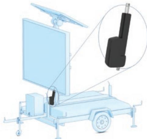
Langer Hub, Schutz gegen raue Umgebungsbedingungen und hohe Traglasten (einschließlich hoher Stoßbelastung durch Windscherung) machen den Electrak HD zur Ideallösung für dieses Straßenbaustellenschild.
